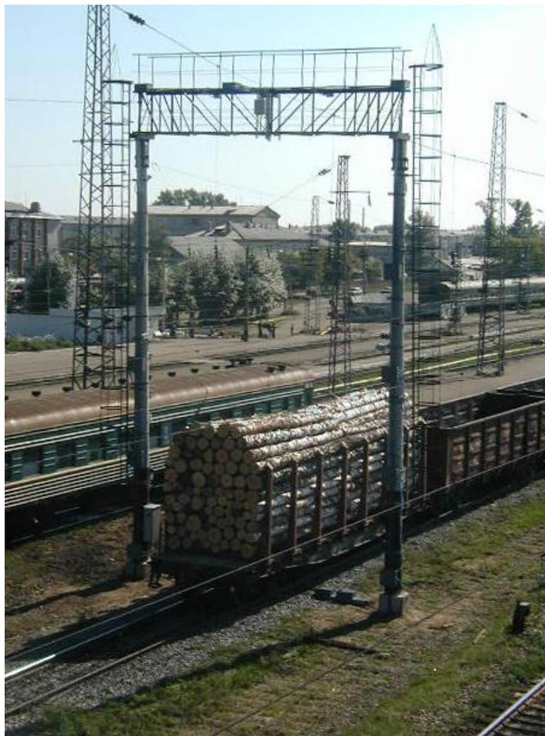
Автоматизированная система коммерческого осмотра поездов и вагонов (АСКО ПВ) предназначена для осмотра движущегося грузового подвижного состава и находящихся на нем грузов и контейнеров с последующим сбором, обработкой, хранением и документированием информации о коммерческом состоянии вагонов и грузов и передачей ее в автоматизированную систему оперативного управления перевозками.
